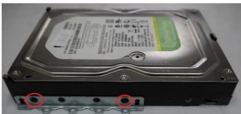
步驟 4. 連接 SATA & 電源線至硬碟，再將其放置外殼的右方。用附件包內的硬碟安裝螺絲將硬碟和支架牢固的固定到機殼。
